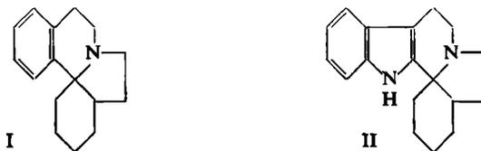
Die synthetische Aufgabe bestand lediglich in der Übertragung des oben skizzierten Verfahrens, dessen praktische Durchführung sich aber von den bisherigen Synthesen unterscheidet. Wird Tryptamin mit Cyclohexanon-(2)-essigsäure-(1) in Xylol einige Stunden erhitzt, so kristallisiert beim Erkalten sofort das Lactam III aus. Seine Konstitution ist durch die Elementaranalyse und das chemische Verhalten eindeutig bestimmt.
